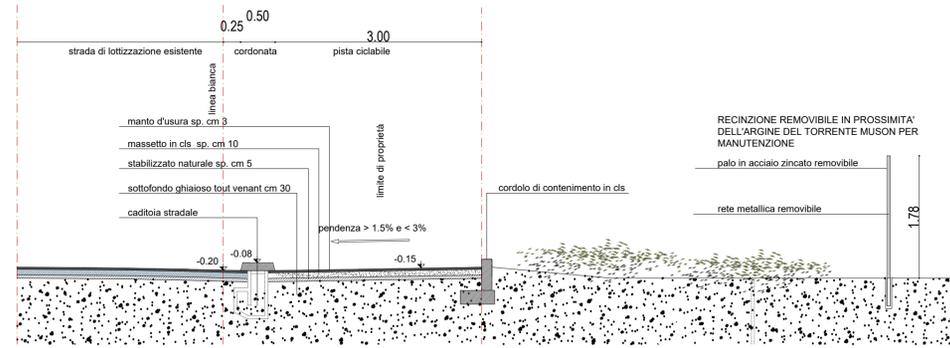
SEZIONE TRASVERSALE TORRENTE MUSON X-X scala 1:20
