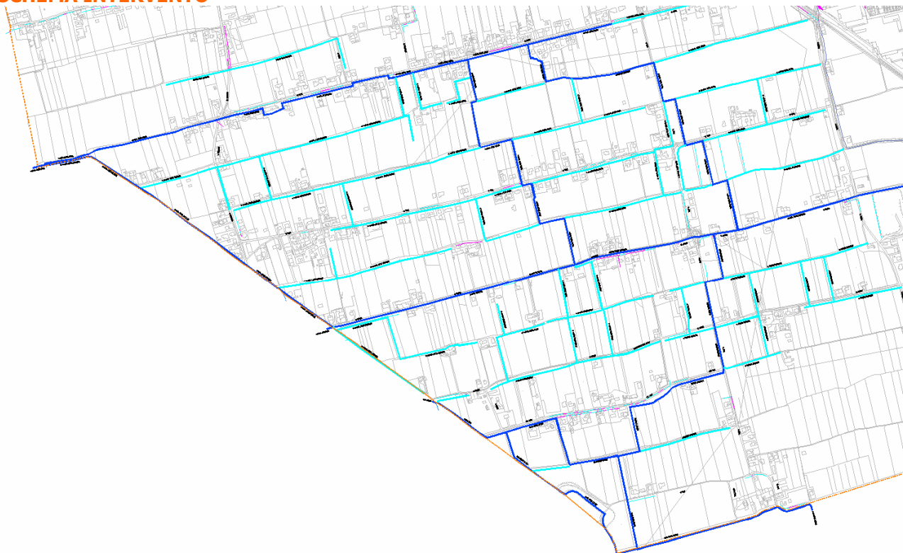
Schema canalette irrigue attive (blu) e dismesse (celeste) a sud di via Grande
